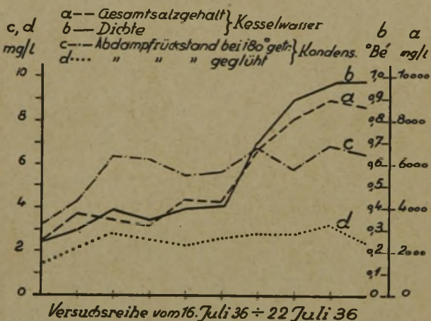
Abb. 4: Salzgehalte des chemisch aufbereiteten Muldewassers und der Kondensate
