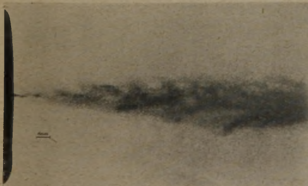
Abb. 14: Strahlinspritzung aus Einlochdüse, Strahlende
