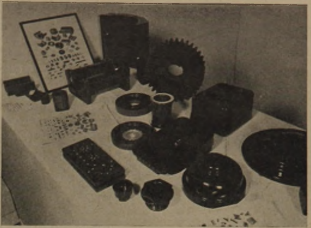
Abb. 6: Lagerschalen, Zahnräder usw. aus Hartgewebe (AEG, Berlin)
