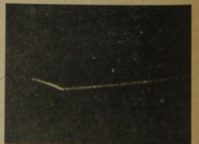
Abb. 8: Umwandlung eines Stickstoffkerns durch ein Neutron
