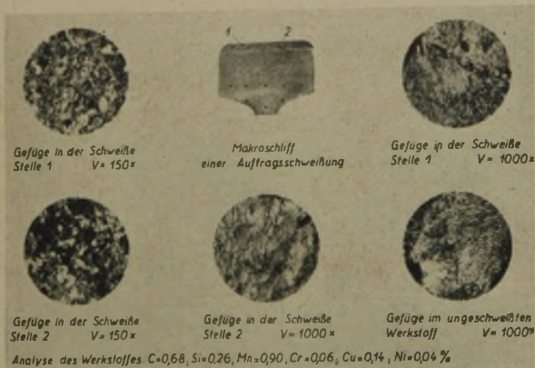
Abb. 5: Anwendung der Autogenschweißung bei Schienenmaterial
