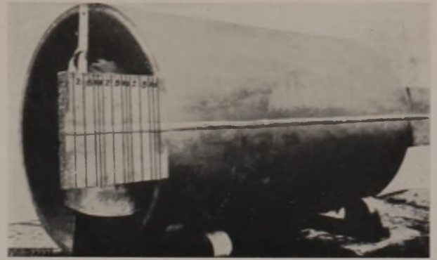
Abb. 2: Kesselschuh mit Probeblechen für die amtliche Arbeitsprüfung
