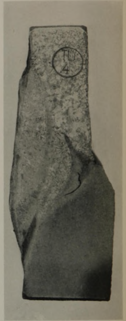
c) Nicht kalibrierte Rohrenden, Bindefehler
