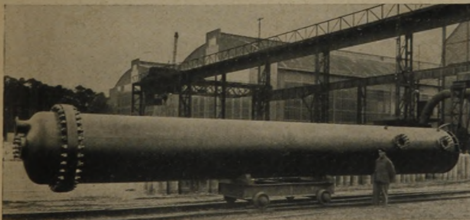
Waschturm von 1450 mm \varnothing und 13000 mm Höhe, 28,5/34,5 mm Wanddicke, für 30 atü Betriebsdruck, vollständig elektrisch geschweißt, im ganzen normal gegläht
