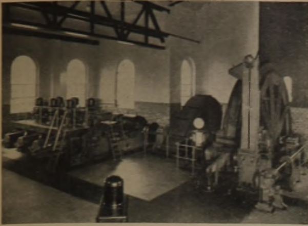
Abb. 15: Dampfhördermaschine, 3-Zylinder-Reihenbauart, 4000 PSe
