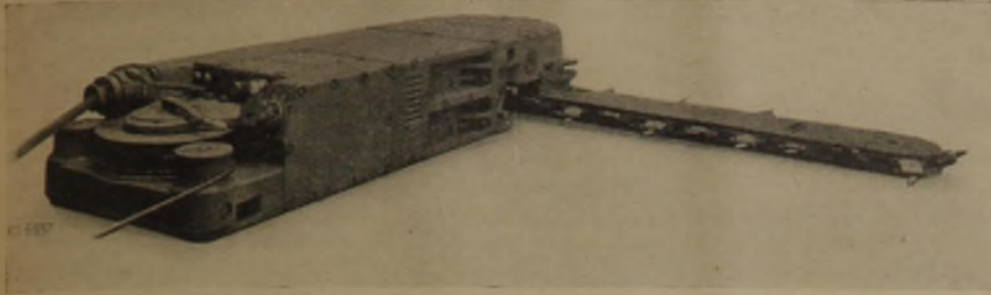
Abb. 3: Schrämmaschine mit druckfest gekapseltem Drehstrom-Kurzschlußläufermotor
