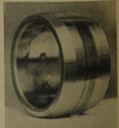
Abb. 65: Riß und Anriß in dem Innenring eines Zylinderrollenlagers
