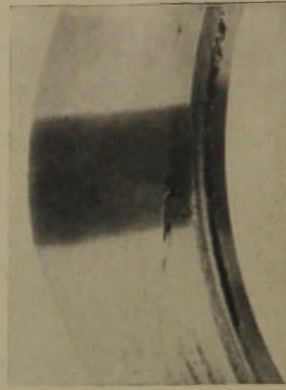
Abb. 7: Abdruck eines Spans auf dem Mantel eines Zylinderrollenlagers
