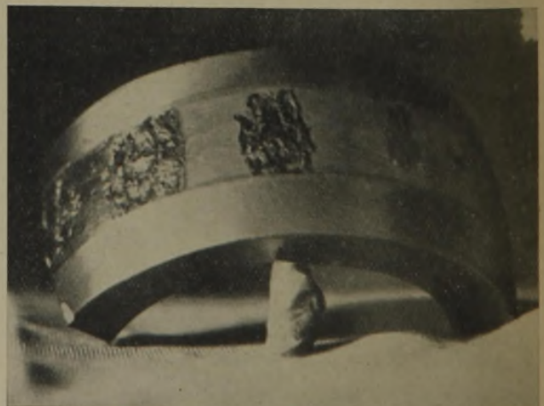
Abb. 28: Weit fortgeschrittene Ausbröckelung der beim Einbau verletzten Stellen der Laufbahn
