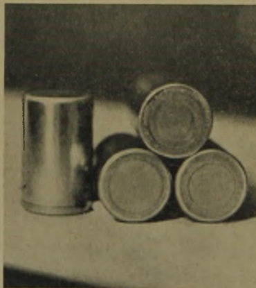
Abb. 39: Freßspuren an den Seitenflächen von Rollen
