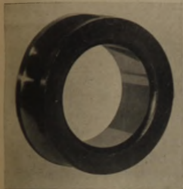
Abb. 32: Hochglanzpolierte (verschlissene) Bohrungsfläche eines Innenringes
