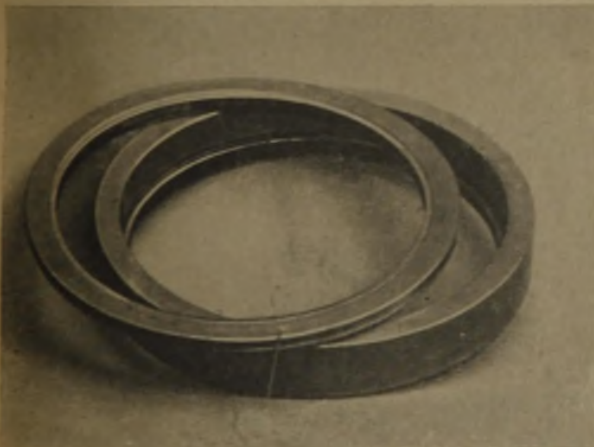
Abb. 43: Verschleiß der Anlagelfläche einer Bordscheibe
