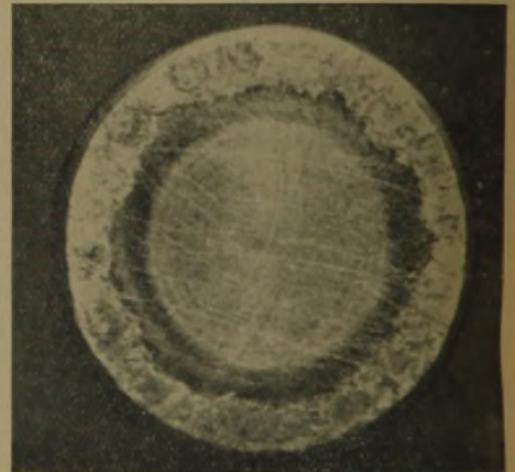
Abb. 40: Freßspuren an der Seitenfläche einer Rolle (schwache Vergrößerung)
