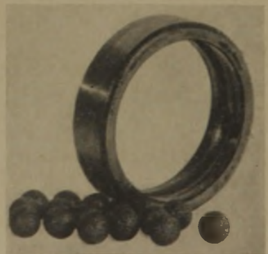
Abb. 47: Sehr stark verrostete Kugeln
