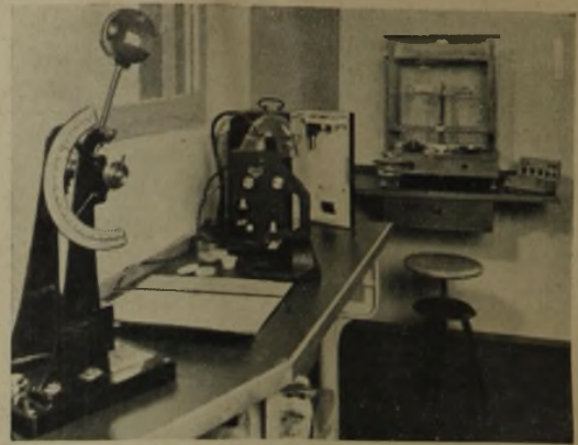
Abb. 7: Prüfapparat für Schleifkorn und Bindemittel
