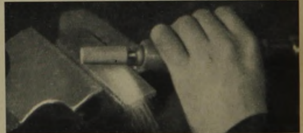
Abb. 14: Das Schleifen ebener Flächen
