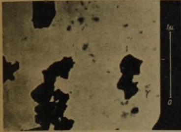
Abb. 9: Gemahlener Feldspat, elektronenoptisch bei einer Vergrößerung von 27 000:1 aufgenommen. Wiedergabe: 18 000:1
