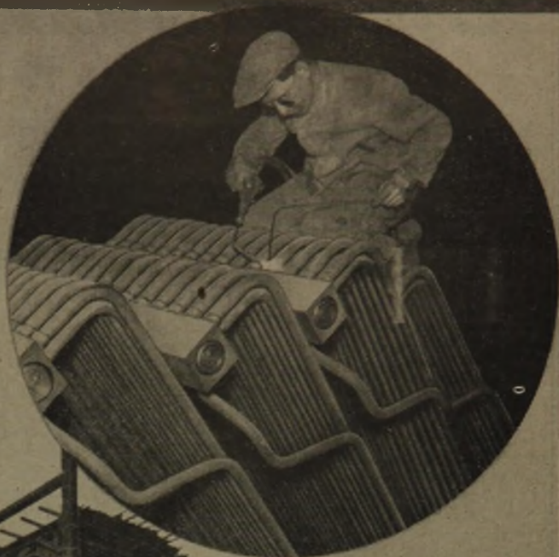
HERSTELLUNG DER ROHR- PAKETE FÜR BENSONKESSEL
