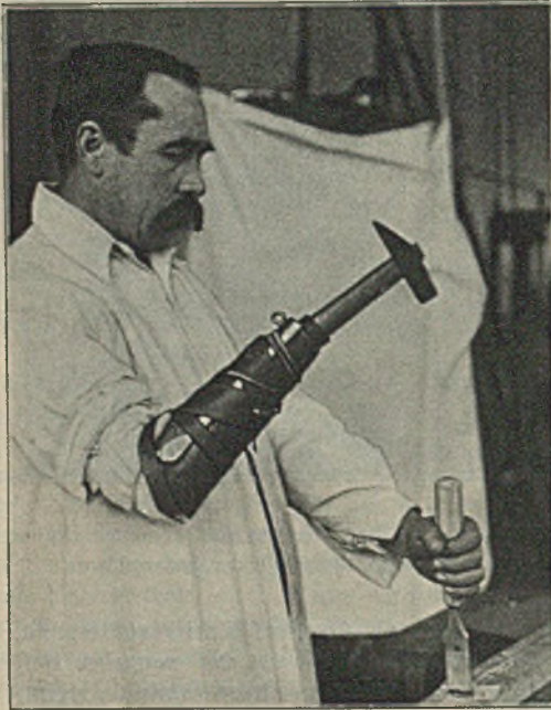
Abbildung 13. Meißeln in Holz mit Stechbeitel und schwerem Hammer.
