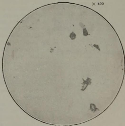
Abbildung 10. Einschlüsse in der äußeren Zone; Probe 3 bis 1030° getempert.
