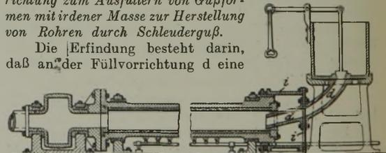
stopfbüchsenartige Kammer i leicht lösbar befestigt ist, die als Ausgleichkammer und zur Aufnahme der beim Gießvorgang aus der Gußform herausgedrückten Luft dient.
