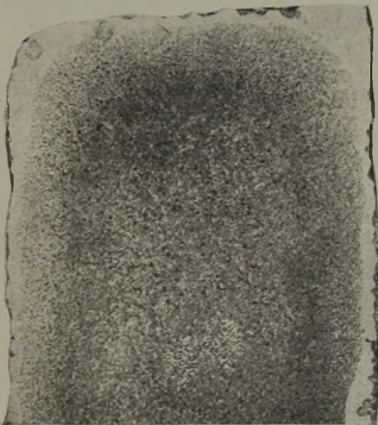
Abbildung 19. Vollständig entkohlte Randzone mit schroffem Uebergang zur Kernzone. In dieser allmäh- licher Uebergang bis zur Mitte. Hier freier Zementit neben Perlit.
