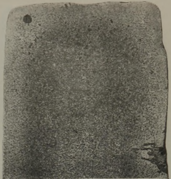
Abbildung 18. Kontinuierlicher Uebergang des Gehaltes an geb. Kohle vom Rand bis zur Mitte. In der Zwi- schenzone mitunter grobe Perlit-Anhäufungen; in der Mitte der Kernzone Zementit.
