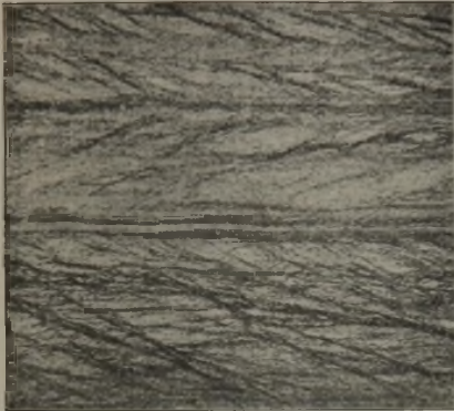
Abbildung 1. Kupfer-Nickel, kalt gewalzt, Längsschliff. Langgestreckte Körner, von dunklen Linien durchzogen, welche die Ebenen darstellen, an denen ein Gleiten während des Walzens stattgefunden hat.
