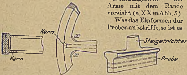
Abbildung 5. Anordnung eines Kernes, um Lunker zu vermeiden.
