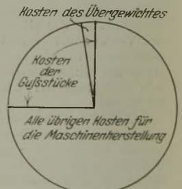
Abbildung 3. Kosten des überflüssigen Gußgewichtes im Verhältnis zu den Gesamtkosten einer leichten Maschine.
