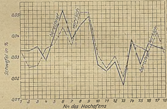
Abbildung 2. Graphische Darstellung der durch Rechnung und Analyse gefundenen Werte für den Schwefelgehalt im Roheisen.
