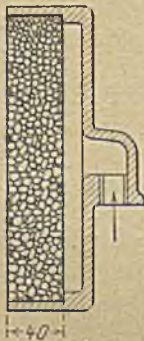
Abbildung 2. Feuerung mit poröser Platte aus hochfeuer- festem Material.
