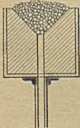
Abbildung 1. Feuerung mit Schüttung feuer- fester Steine.
