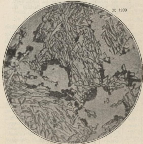
Abbildung 5. Stahl mit 0,64% C, bei 900° abgeschreckt und bei 710° angelassen, dann nochmals abgeschreckt.
