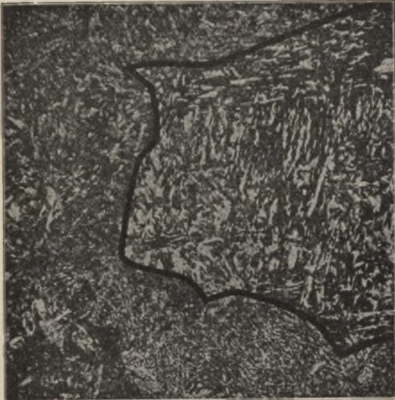
Abbildung 3. Stahl mit 0,64% C, bei 900° abgeschreckt und bei 620° angelassen.
