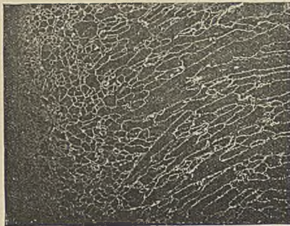
Abbildung 13. Blockgefüge eines im Gespann von oben vergossenen 2400-kg-Blockes. (Randstelle aus dem Fuße des Blockes.)
