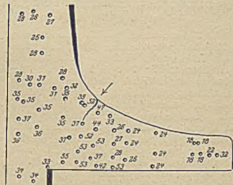
Abbildung 1. Skleroskophärteszahlen in dem Längsschnitt einer Messinghülse.
