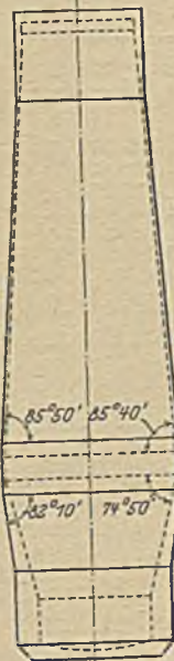
Abbildung 2. Profil eines rheinisch-westfälischen Ofens von 4,5 m Gestellweite im Profil des Ofens VI der Südwerke.
