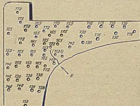
Abbildung 2. Brinellhärteszahlen in dem Längsschnitt einer Messinghülse.
