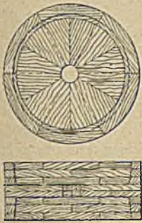
Abbildung 13. Mittelscheibe aus Segmenten verleimt.
