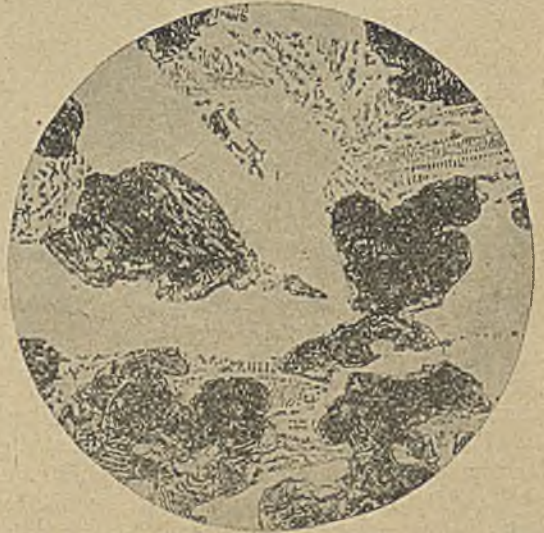
Abbildung 14a. Probe 1. \times 600 Weiße Zone, geätzt.
