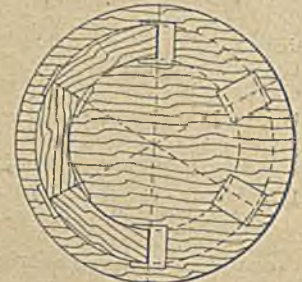
Abbildung 4. Aufleimen der Segmentringe auf Papier.
