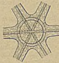
Abbildung 25. Armkreuz mit durchgehenden Rippen. Die Nabe wird in 6 Keilstücken zwischen die Rippenwinkel eingesetzt.
