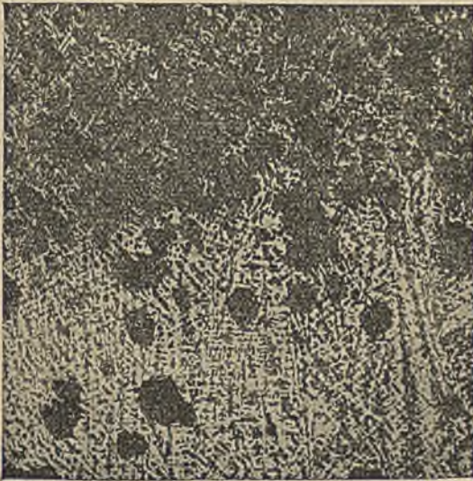
Abbildung 19. Probe 2. \times 25 Uebergang zwischen dem grauen Teil und dem weißen Kern, geätzt.
