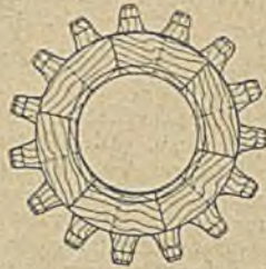
Abb. 2. Modell für Räder von 100 bis 200 mm Durchm., verleimt aus Segmenten mit tangentialer Faserrichtung.
