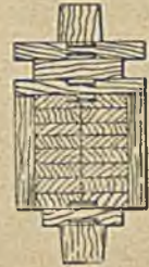
Abbildung 18. Einseitig überlapptes Triebel mit Kupplungsscheibe.
