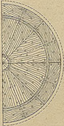
Abbildung 13. Mittelscheibe aus Segmenten verleimt.
