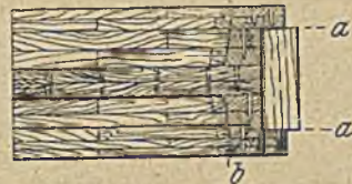
Abbildung 15. Größeres Stirnradmodell mit halbüberlappenden Zähnen.
