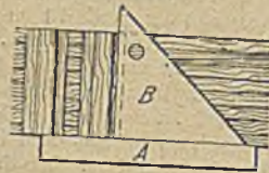
Abbildung 8. Prüfung der lotrechten Lage der Zähne mit Lineal A und Winkel B.
