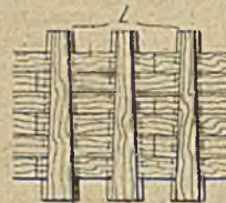
Abbildung 10. Schwalbenschwanzverzinkung der Zähne im Zahnkranze.
