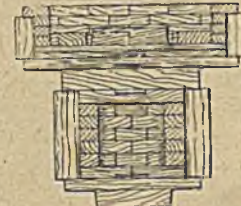
Abbildung 20. Kupplungsrad und Triebel zu einem Abguss vereinigt.
