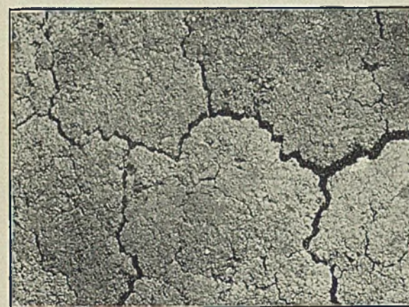
Abbildung 7. Wandfläche von Koks bei kaltem Ofengang.
