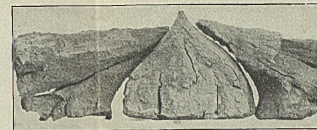
Abbildung 14. Normale Koks-bildung der Sohlenlage in einem Koppers-Regenerativofen.
