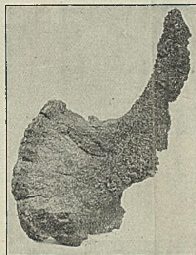
Abbildung 11. Koks aus schlecht gemischter Kohle mit Schwammkoks-fortsatz.
