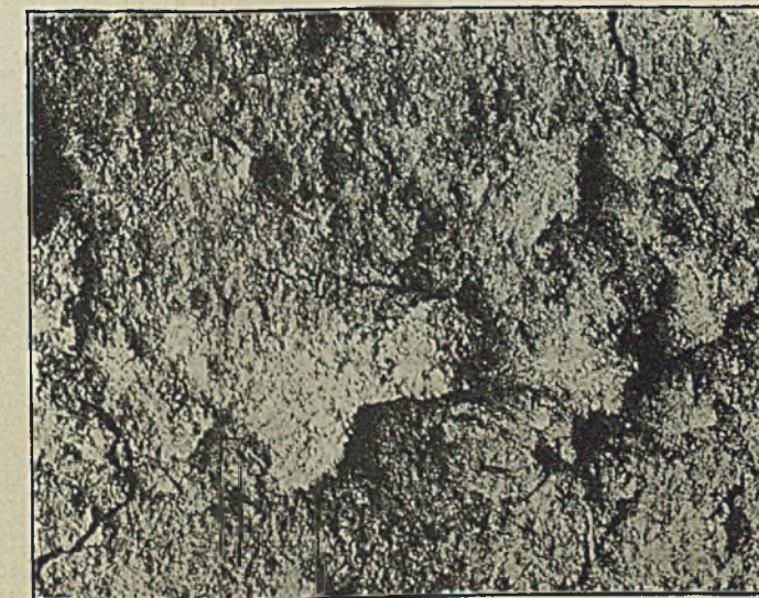
Abbildung 36. Koks aus Kohle wie in Abb. 33, mit 10% Anthrazitstaub gemischt; gestampft beschickt.
