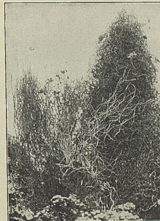
Abbildung 19. Kokshaargebilde auf Bienenkorb-ofenkoks.
