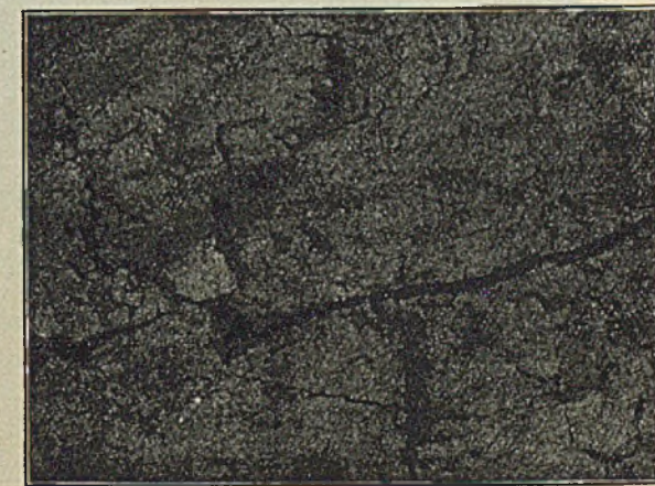
Abbildung 41. Koks aus einer wie in Abb. 40 auf- bereiteten Mischung mit 15% Pechzusatz.
