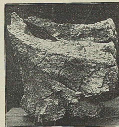
Abbildung 13. Koks von einer beheizten Koks-ofensohle.
