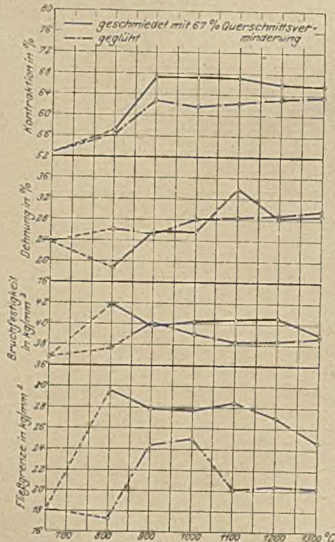
Abbildung 3. Festigkeitseigenschaften in Abhängigkeit von den Anfangsschmiedetemperaturen 800 bis 1300° bei 67% Querschnittsverminderung.
