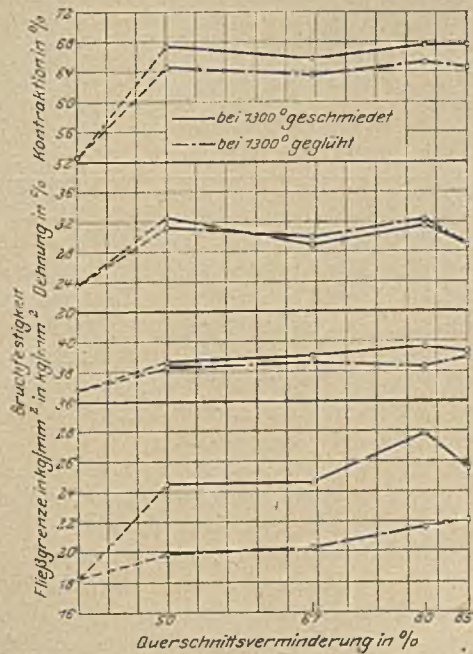
Abbildung 12. Festigkeitseigenschaften in Abhängigkeit von dem Grade der Verschmiedung bei 1300° Anfangsschmiedetemperatur.
