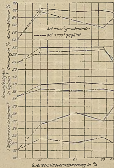
Abbildung 10. Festigkeitseigenschaften in Abhängigkeit von dem Grade der Verschmiedung bei 1100° Anfangsschmiedetemperatur.
