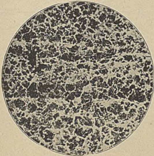
Abbildung 22. \times 100 Probe B 11 (Längsschliff). Schmiedeintervall 800 bis 680°. Querschnittsverminderung 80 %. 2 st geglüht bei 820°.
