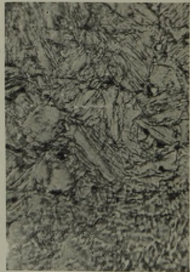
Abbildung 17. Nadeliges Nitrierungsgefüge in ursprünglich osmonditischem Chrom-Nickelstahl „Straußit“.
