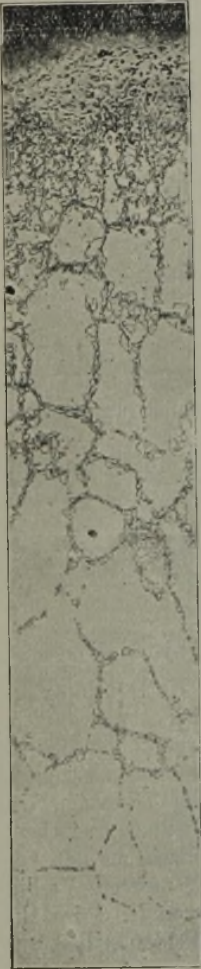
Abbildung 1. Elektrolyteisen, in \text{NH}_3 6\frac{1}{2} st bei 680° nitriert. Langsame Abkühlung. Aetzung: Pikrinsäure.
