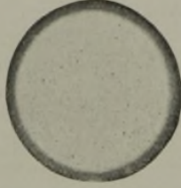
Abbildung 15. Gleiches Stück wie Abb. 14 Feinschliff, mit Pikrinsäure geätzt.
