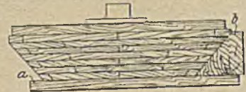
Abbildung 37. Lehren zum Abdrehen der äußeren Schrägung.
