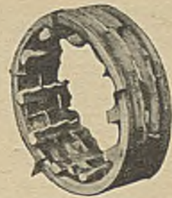
Abbildung 7. Abguß mit vier Kolbenringen unmittelbar nach der Entnahme aus der Form.
