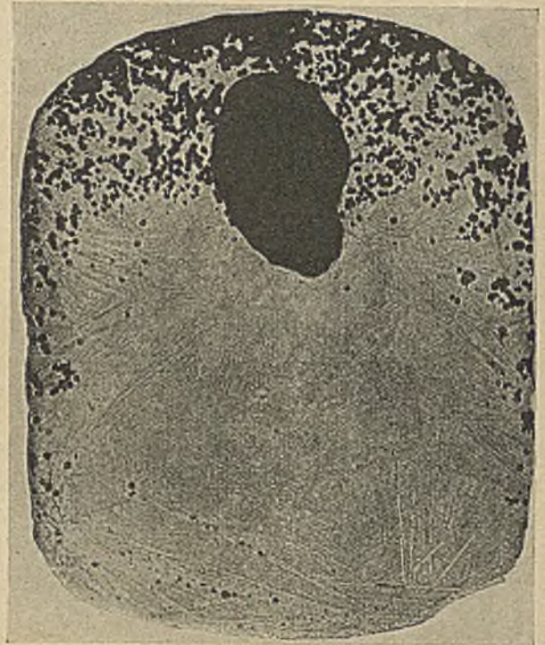
Abbildung 31. \times 5 Probe 4. Künstlicher umgekehrter Hartguß.
