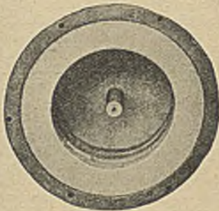
Abbildung 5. Formkasten nach Einlegung der Abschlusskernlage A.
