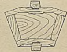
Abbildung 39. Triebelmodell mit aus dem Vollen gedrehtem Körper. Zähne beiderseits ganz überlappt.
