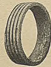
Abbildung 8. Mittels Lebrn hergestellter Klotz von 5 Ringen.
