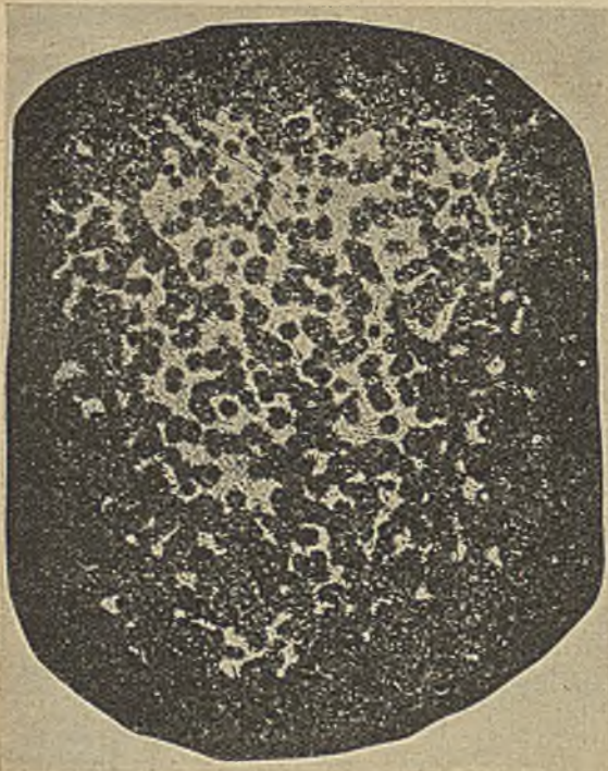
Abbildung 30. \times 5 8 st bei 950 bis 1000° im Vakuum gegläht.
