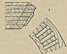
Abbildung 42. Ausschnitt aus einem Kammradmodellkranz mit abgepaßten Kernmarken.
