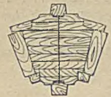
Abbildung 40. Triebelmodell mit verleimtem Körper. Zähne beiderseits halb überlappt.
