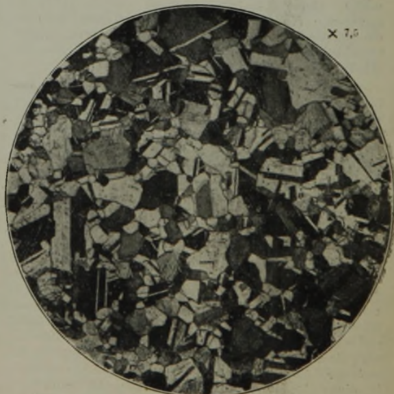
Abbildung 1. Heißätzung im Stickstoffstrom, 20 st, 1300°, Kesselblech.
