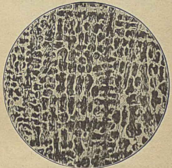
Abbildung 12. Typisches Gefüge des Rombacher Holzkohlenroheisenersatzes mit 1,0 % Si, 0,04 % S, 3,05 % C.
