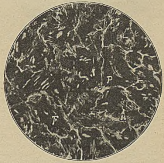
Abbildung 10. Versuchsschmelze, mit Holzkohle gekohlt, mit 1,13% Si, 0,04% S, 1,95% C.
