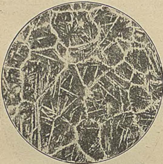
Abbildung 5. Versuchsschmelze mit 0,6% Si, 1,7% C. 13. Mai 1915.
