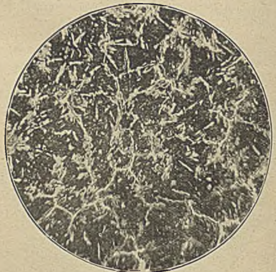
Abbildung 6. Versuchsschmelze mit 0,8% Si, 1,7% C. 1. Juni 1915.
