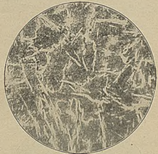
Abbildung 9. Versuchsschmelze, mit Holzkohle gekohlt, mit 0,06% Si, 0,04% S, 1,90% C.
