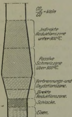
Abbildung 1. Hochofengang bei schwer reaktionsfähigem Koks.
