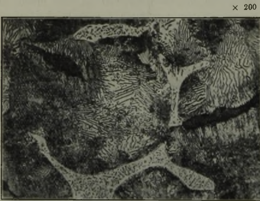
Abbildung 5. Eisen mit 0,78% geb. C, geätzt.
