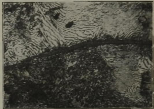
Abbildung 3. Perlitguß mit niedrigem S-Gehalt.
