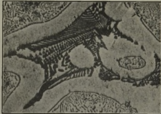
Abbildung 5. 0,6% C, 18% W, 4% Cr. Schnellstahl im Gußzustande mit Aetzmittel Murakami-Daeves geätzt. Gefüge besteht aus Eutektikum, strukturlosem Wulst und Mischkristallen mit Zementit. (Perlit?)
