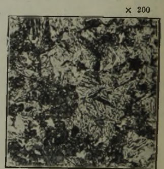
Abbildung 16. Werkstoff B, bei 850° in Oel abgeschreckt.
