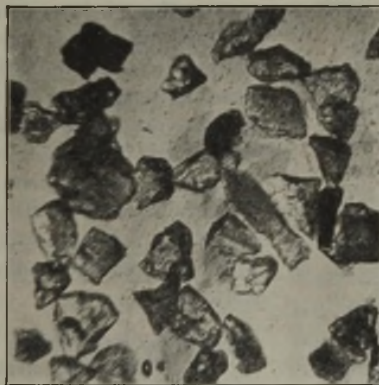
Abbildung 4. Schwedischer Elektrozetment (Pulverpräparat, abgesiebt zwischen dem 2500- und 4900-Sieb), gew. Licht.
