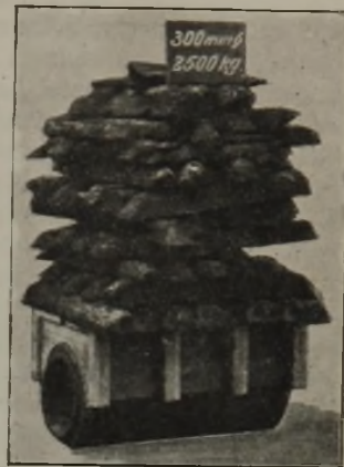
Abbildung 1. Druckprobe des Schlackenrohres.
