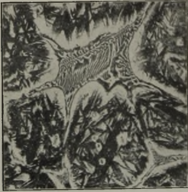
Abbildung 5. Aetzung: Schweflige Säure. 18 W 0,4 V bei 1350° gehärtet.
