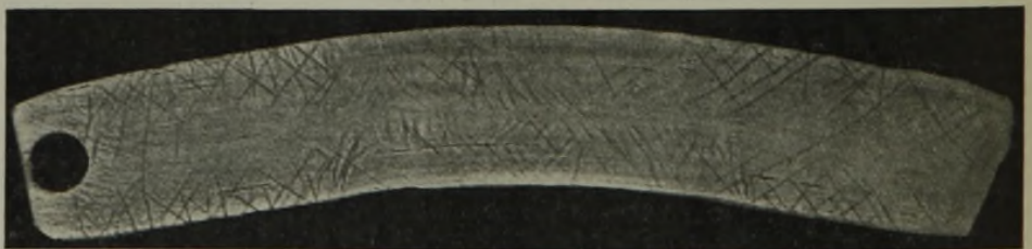
Abbildung 2. Dieselbe Probe wie Abbildung 1, \frac{1}{2} st elektrolytisch geätzt mit Zusatzstrom. Elektrolytlösung: 300 g \text{FeCl}_3 , 10 ccm \text{HCl} , 3000 ccm \text{H}_2\text{O} .
