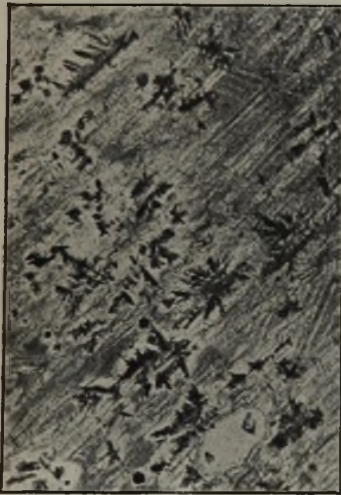
Abbildung 2. Desgl., angereichert mit Mangan (3,0 % MnO). Tannenbaumähnliche, gesetzmäßig geordnete Manganskelette in farblosen Höfen des reinen Melilit.
