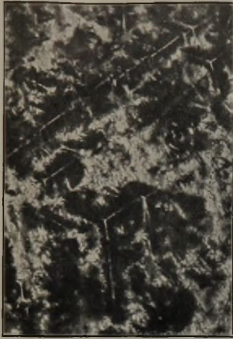
Abbildung 3. Desgl., angereichert mit Mangan (5,0 % MnO). Wie Abbildung 4, stärkere Manganausscheidung.
