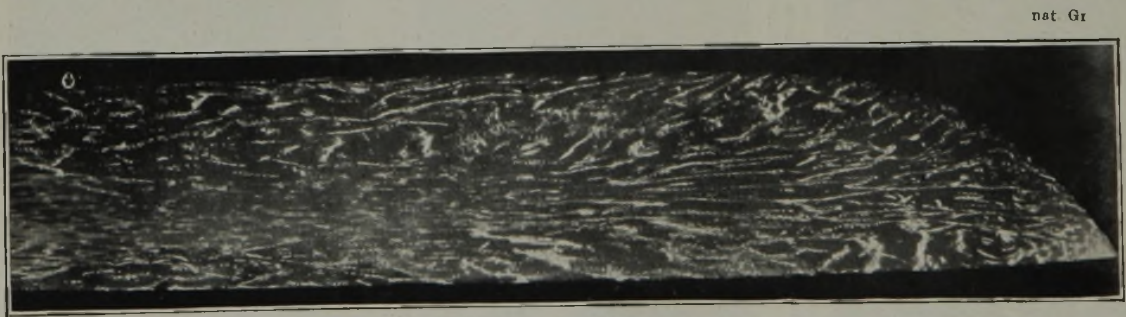
Abbildung 3. Weitere Zertrümmerung der Fe_3C -Nadeln.
