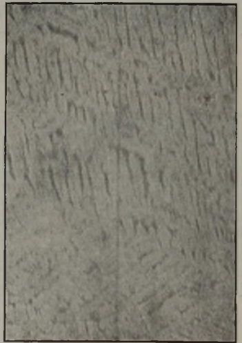
Abbildung 4. Desgl., angereichert mit Mangan (9,8 % MnO). Manganverbindung in Dendriten zwischen den klaren Melilitkristallen ohne Ordnung ausgeschieden und eingeschlossen.
