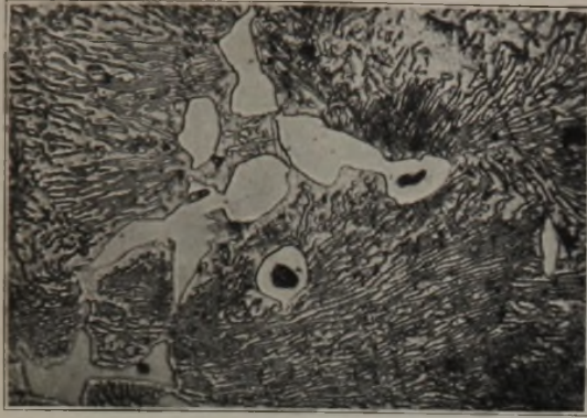
Abbildung 3. C 1,43 %, Si 0,26 %, Mn 0,18 %. \frac{1}{2} st bei 1030° geglüht, in 3 st von 1030 auf 850° abgekühlt. Temperkohle 0,36 %. Graphitkeime. Alk. Salpetersäure.
