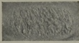
Abbildung 10. Bruchgefüge eines Stahles mit gleichem Kohlenstoffgehalt wie B 3 , aber 0,32% Mn und 0,27 % Si, Härtetemperatur 830°.
