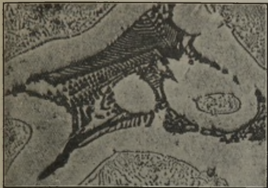
Abbildung 2. 0,6% C, 18% W, 4% Cr. Schnellstahl im Gußzustande mit Aetzmittel Murakami-Daevs geätzt. Gefüge besteht aus Eutektikum, strukturlosem Wulst und Mischkristallen mit Zementit. (Perlit?)
