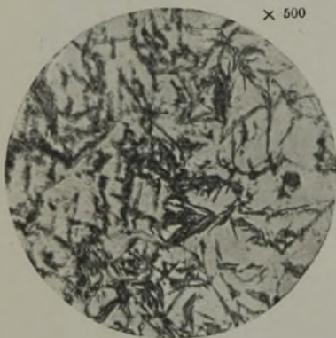
Abbildung 1. Aus dem Einsatz in Oel gehärtet. Austenit mit Martensitnadeln. Aetzung II.
