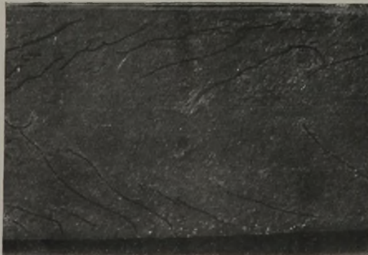
Abbildung 12. Härterisse infolge Oberflächen-Entkohlung nach Tiefätzung in 5% H_2SO_4 .
