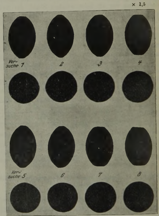
Abbildung 5. Profilquerschnitte der Oval- und Rundstiche aus Versuchen 1 bis 8.
