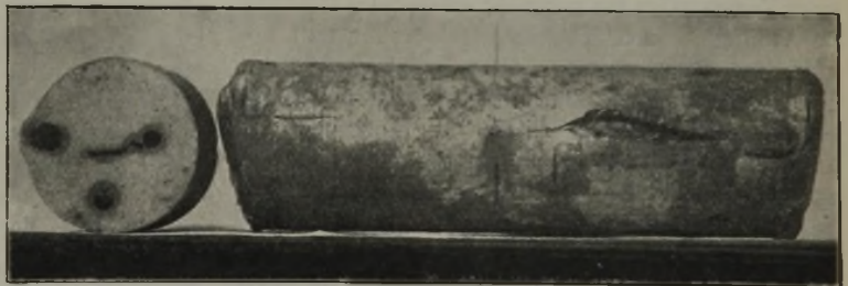
Abbildung 7. Versuchskörper mit Bohrlöchern mit eingestampftem phosphorhaltigem Eisensilikat nach der Zementation. Links Querschliff mit Kupfer-Ammoniumchlorid geätzt.
