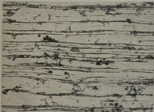
Abbildung 7. Eisensiliziumband mit 4,6 % Si, warmgewalzt, 2 mm stark. Aetzung II.
