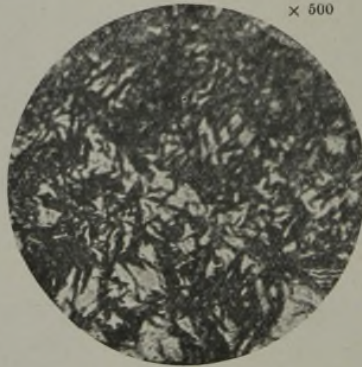
Abbildung 2. Wie Abbildung 1, aber mit Schlußhärtung bei 780° grobnadl. Martensit und Austenit. Aetzung II.
