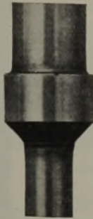
V 2 A in 10 Monaten Betriebsdauer 6mal nach- geschliffen.
