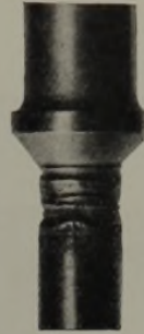
Stahlbronze in 6 Monaten Betriebsdauer 16mal nach- geschliffen.
