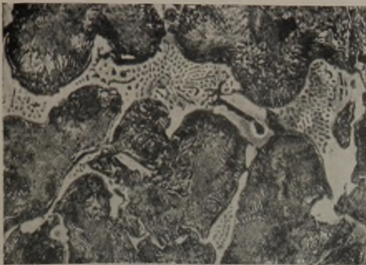
Abbildung 2. Ledeburit in weißem Gußeisen mit niederm Kohlenstoff. × 200
