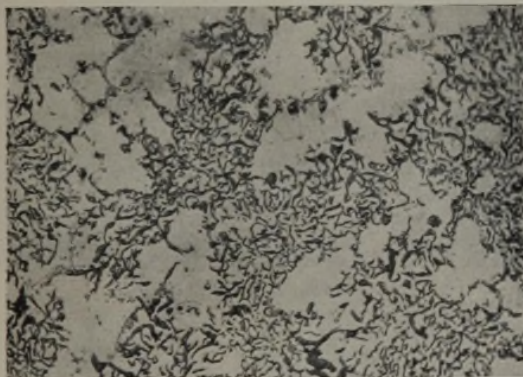
Abbildung 7. Feines Graphiteutektikum in einem in Kokille gegossenen Spindelbüchsenmaterial bei 15 mm Ø. × 200
