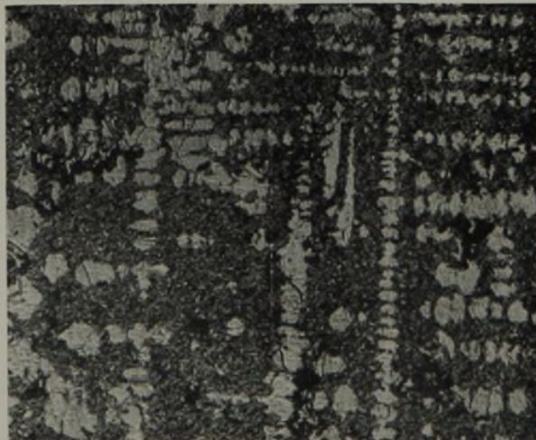
Abbildung 10. In 20-mm-Ø-Kokille gegossenes Eisen mit 3,5 % Si, geglüht. Die primär ausgeschiedenen Tannenbaummischkristalle sind ferritisch. Die beim Zerfall entstandene Temperkohle hat sich an den eutektischen Graphit als Keimpunkt angeschlossen. Graphiteutektikum wie in Abb. 8.
