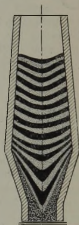
Abbildung 1. Niedergang der Beschickungs- massen im Hochofen.
