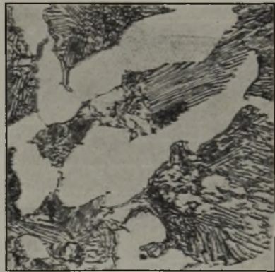
Abbildung 6. Linkes Teilbild aus Abbildung 5 zeigt in stärkerer Vergrößerung, daß die schwarzen Flächen der Abbildung 5 in Wahrheit aus streifenförmig nebeneinander liegenden Zementit- und Ferritadern (streifiger Perlit) bestehen. Die großen weißen Flächen stellen Ferrit dar. Die Stelle enthält etwa 0,4 % C.
