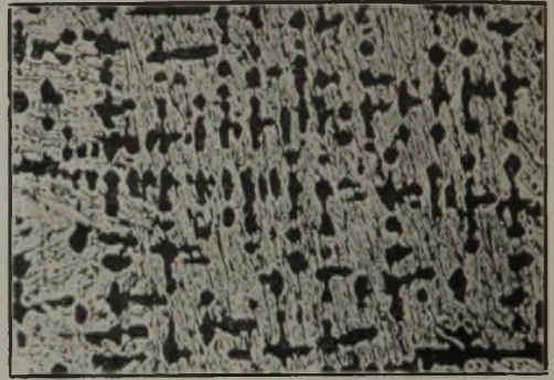
Abbildung 11. Gefüge eines untereutektischen Roheisens mit etwa 3 % C. Die dunklen, tannenbaumförmig angeordneten Stellen entsprechen den primären Mischkristallen. Die gespenkelte Grundmasse ist Ledeburit.
