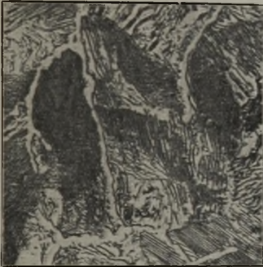
Abbildung 8. Rechtes Teilbild aus Abb. 5 in stärkerer Vergrößerung. Perlit, umgeben von weißen Zementitbändern. Der Perlit liegt teils in streifiger, teils in Uebergangsformen zum Sorbit (dunkel) vor. Die Stelle enthält etwa 1,2 % C.
