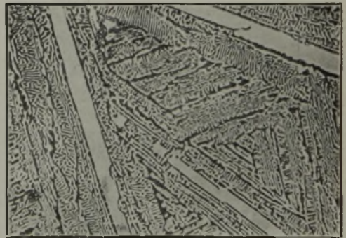
Abbildung 13. Uebereutektisches Roheisen mit etwa 5 % C. Weiße primäre Zementit-Nadelkristalle in der Grundmasse des Ledeburits.
