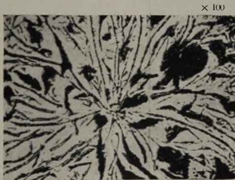
Abbildung 4. Gefüge am Uebergang der hellen Kernzone zur dunkleren Zwischenzone gemäß Abb. 1 b u. Abb. 3.
