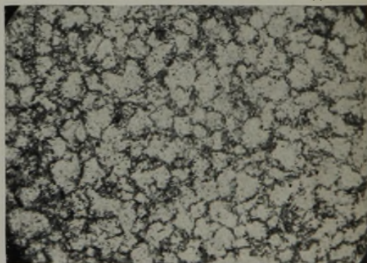
Aetzung: Natriumpikrat. Abbildung 9. Wasserhärtung bei 825° C. Erhitzungsdauer 10 min.
