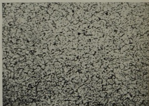
Aetzung: Natriumpikrat. Abbildung 8. Oelhärtung bei 800° C. Erhitzungsdauer 10 min.
