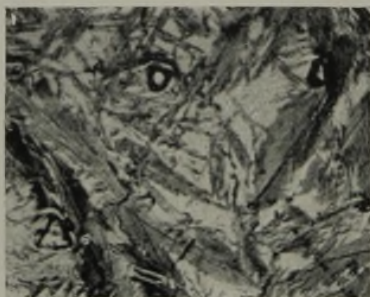
Abbildung 1. B 5 (C = 1,29 %, W = 4,8 %). Bei 1200° abgeschreckt. Aetzung: HNO 3 .
