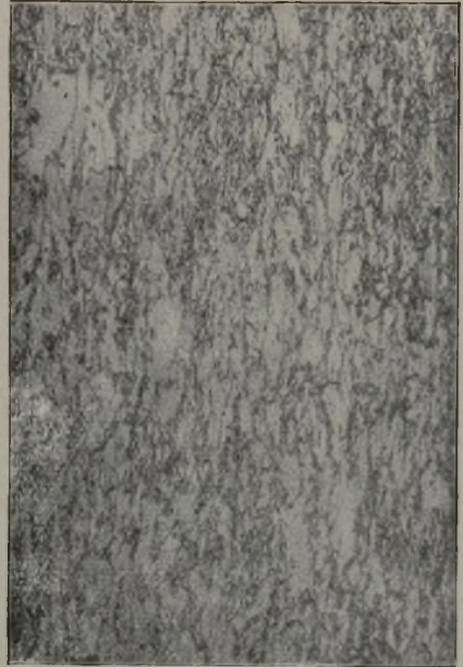
Abbildung 22. Mikrophotographisches Bild eines gezogenen Flußeisendrahtes.
