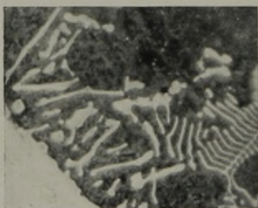
Abbildung 3. Schweißprobe W mit Stahl 1,79 % C, Wolframseite. Bei 1150° abgeschreckt. Aetzung: angelauten.
