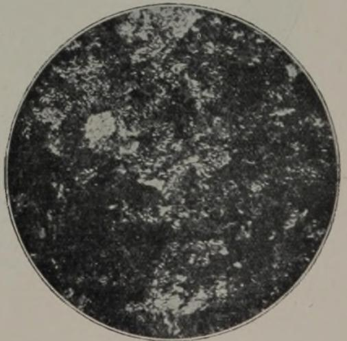
Abbildung 27 a bis f. Gezogener Draht, 0,85 % C. Die Glühtemperaturen wurden mit Absicht etwas zu hoch gewählt, um den Einfluß auf das Gefüge besonders anschaulich zu machen. Bei 0,85 % C hätte jeweils eine Temperatur von 750 bis 800° genügt. Zertrümmerter Perlit, entstanden durch Kaltbeanspruchung beim Ziehen. In den Längsschliffen ist nur eine sehr geringe Zugstreckung zu beobachten.
