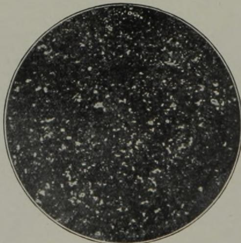
Abbildung 36. Patentgußstahldraht mit 0,64 % C. Laut Abbildung 35 behandelter Draht, in Oel von 320° 1/2 st angelassen. Troostit und beginnende Sorbitbildung. Die in den Längsschliffen beobachtete geringe Zugstreckung verschwindet schon nach der ersten Wärmebehandlung vollständig.
