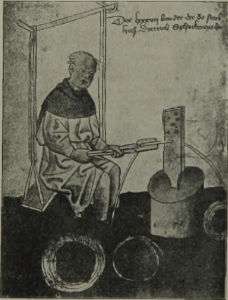
Abbildung 2. „Schocken“-Zieher. Anfang des 15. Jahrhunderts. Aus den Stiftungsbüchern des Mendelschen und Landauerschen Zwölfbrüderhauses zu Nürnberg. (Nürnberger Stadtbibliothek.) Nach Feldhaus: Anz. Drahtind. 19 (1910), S. 137.
