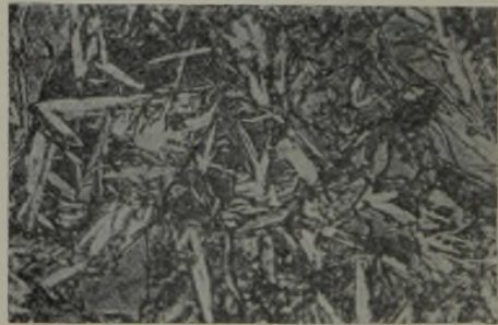
Abbildung 7 b. Stahl mit 1,7 % C bei 1100° in Eiswasser abgeschreckt.
