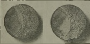
Abbildung 4. Abbildung 5. Dauerbrüche an Bohrern.
