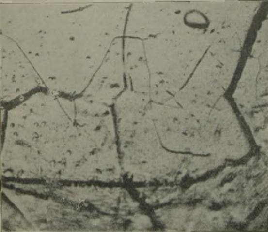
Abbildung. 1. Oberfläche von im Vakuum erschmolzenem Elektrolyseisen (unterer Teil nicht poliert, oberer Teil poliert und geätzt).
