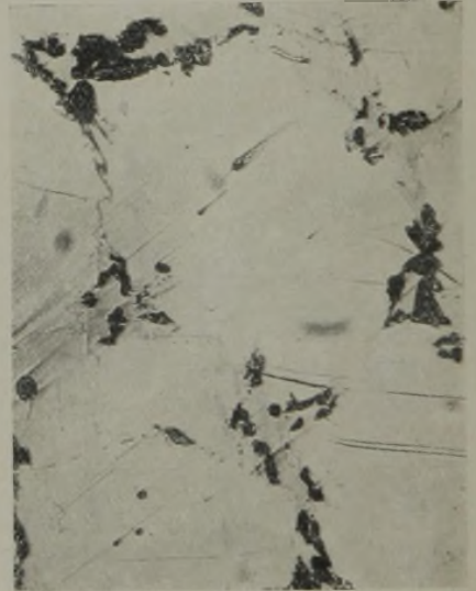
Abbildung 8. Dieselbe Stelle wie Abb. 7, jedoch neutrale Pikratätzung.
