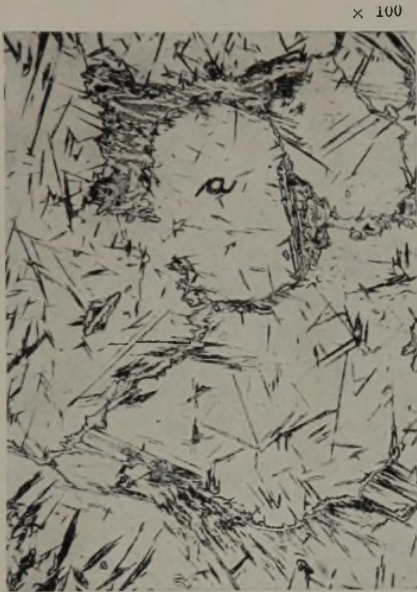
Abbildung 1. Rohgußgefüge. Pikrinsäure- ätzung.
