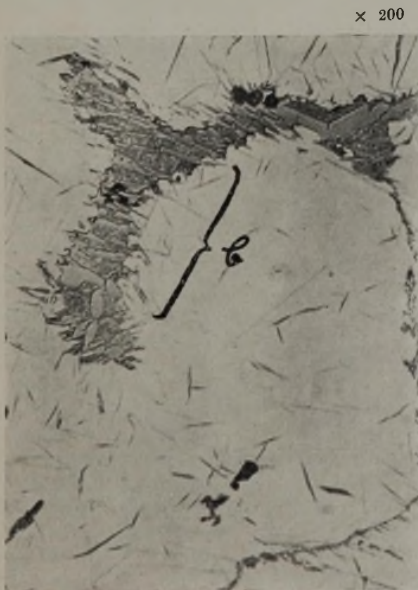
Abbildung 2. Stelle a aus Abb. 1. Aetzung mit alkalischem Natriumpikrat.
