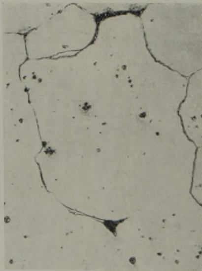
Abbildung 9. Dieselte Stelle wie Abb. 7 und 8, nach Glühung und Zähhärtung. Pikrinsäureätzung.
