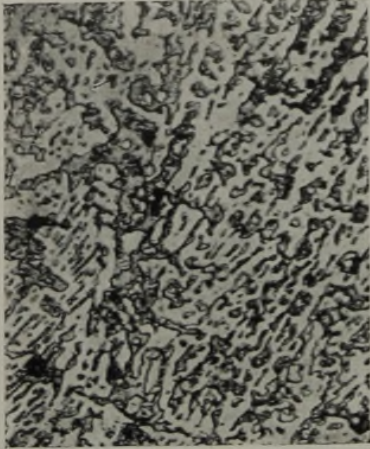
Abbildung 10. Schwach mit 5 % \text{HNO}_3 /Alk. geätzt. Gefüge des gependelten, weißen, schwedischen Roheisens ohne Silizium. Vgl. Abb. 6.
