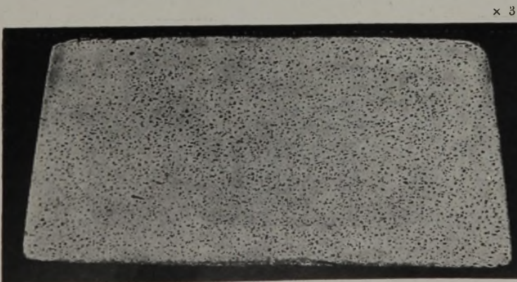
Abbildung 13. Dickwandiger Schwarzkernguß mit 1,0 % Schwindung.
