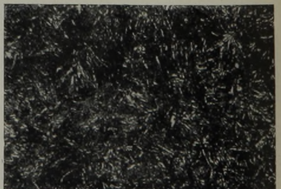
Abbildung 12. Stahl 14 C von 1050° in Salzwasser abgelöscht, bei 500° 30 min angelassen.
