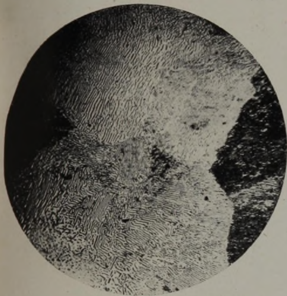
Abbildung 3. Stahlguß mit 0,75 % C (Aetzung: alkoholische Salpetersäure).
