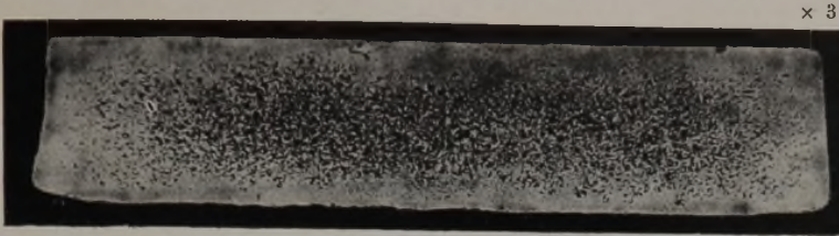
Abbildung 10. Dünnwandiger Weißkernguß mit 2,0 % Schwindung.
